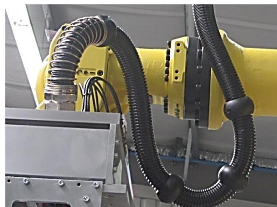
Schnelle ruckartige Bewegungen mit hohem Drehwinkel > 400° Quick jerky movements with high rotational angle > 400°
